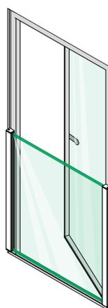
Montaje entre las jambas del hueco de la ventana
