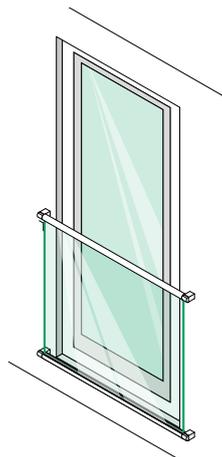
Montaje por delante de la fachada con tubo redondo vertical
