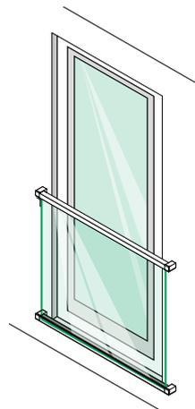
Montaje por delante de la fachada con tubo angular vertical
